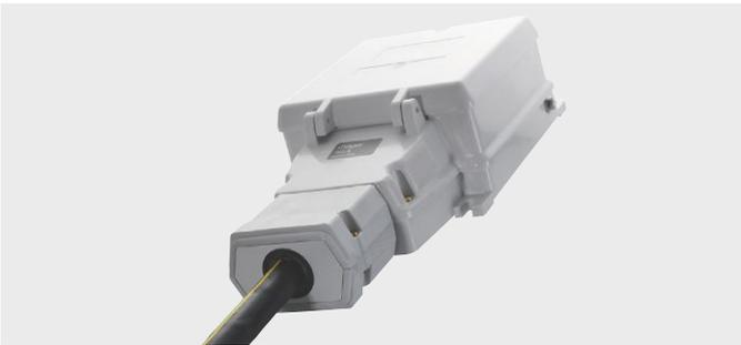
Le module EER peut également servir de boîte pour masse isolante. Pour garantir l'étanchéité lors du remplissage de la coquille, il faut graisser les surfaces de contact des demi-coquilles ou bien colmater le joint. Cela permet un raccordement en bonne et due forme de câbles en plomb.
